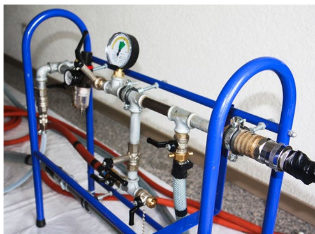
Spülstation mit Drucküberwachung
